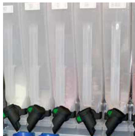
Drehverschlüsse der Instantbehälter mit einer optischen Anzeige für offen (grün) und verschlossen (rot)
