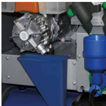
Direkte Weitergabe der gemahlene Bohnen in einem Trichter direkt von der Mühle in den Brüher
